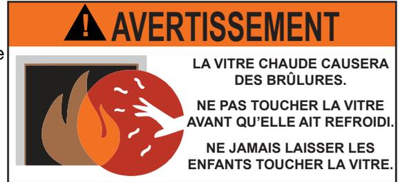
Ne touchez pas la surface intérieure de la vitre avec des lames de rasoir, de la laine d'acier ou d'autres objets métalliques puisque la mince couche de métal retirée de l'objet pourrait se déposer sur le revêtement causant une décoloration ou une égratignure. De telles marques ne peuvent être enlevées en utilisant les procédés de nettoyage habituels, elles exigent des procédés spéciaux.
